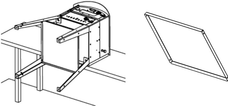
Positionnez les 4 renforts. Mettez les 8 vis sans les serrer complètement. Attention, le renfort arrière est différent, il dispose de deux perçages.
